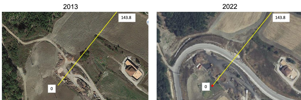
Figura 2: Analisi temporale della costruzione del rilevato fino alla data del collasso.
