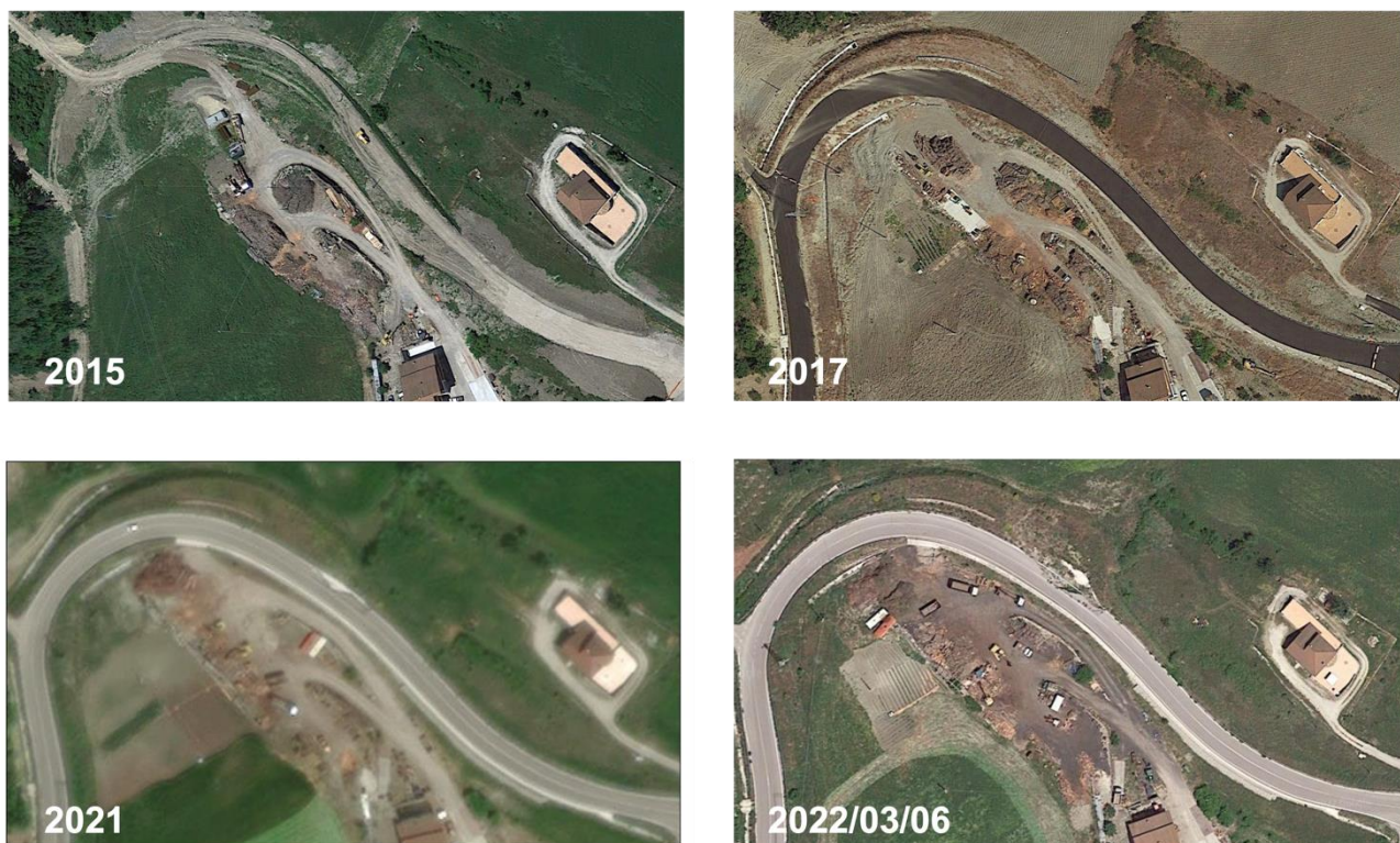
Figura 2: Analisi temporale della costruzione del rilevato fino alla data del collasso.
