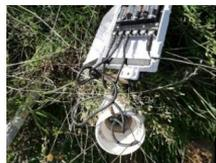
Sensori per la misura del potenziale idrico e della temperatura (MPS-6)
