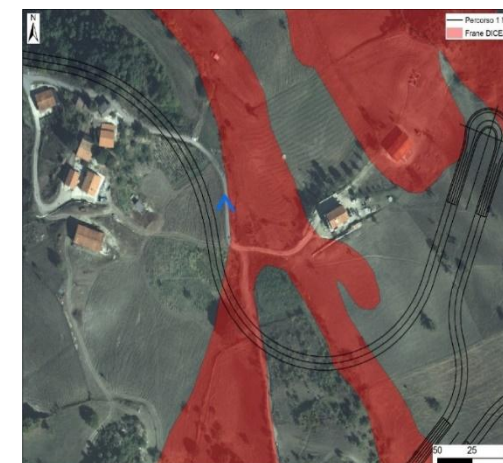
Chiare evidenze di deformazioni al suolo per presenza di frane attive
