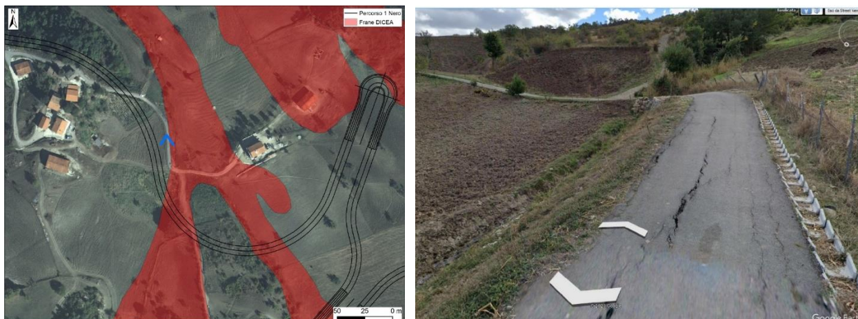
Figura 17. Chiare evidenze di deformazioni al suolo per presenza di frane attive.
