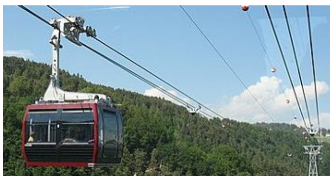
Figura 11: Sistema 3S 4 caratterizzato da due funi portanti per ciascuna via di corsa ed una fune traente in moto continuo alla quale sono agganciate temporaneamente numerose cabine (nelle prime due immagini sono evidenti i sostegni per la fune traente collocati in campata fra le due portanti).
