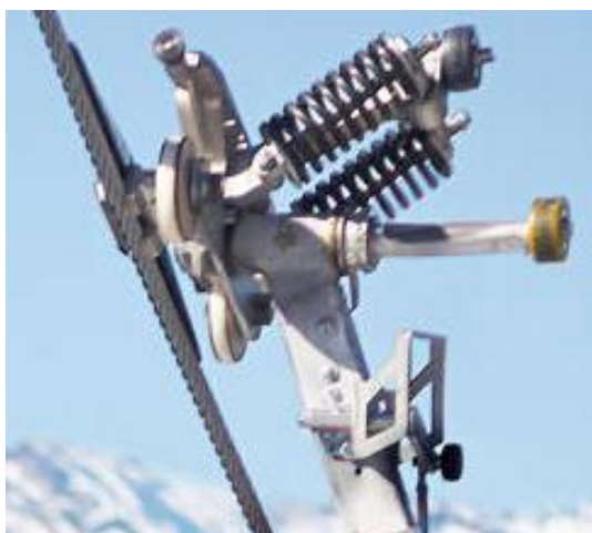
Figura 6: Morsa automatica per agganciamento temporaneo dei veicoli alla fune
