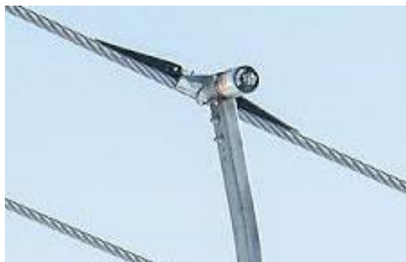
Figura 5: Morsa fissa per agganciamento permanente dei veicoli
