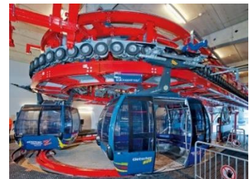
Figura 10: Sistema Funitel 3 caratterizzato da due funi (entrambe con funzione portante e traente) in moto unidirezionale, costituite da un unico anello impalmato, alle quali sono agganciate temporaneamente più cabine.
