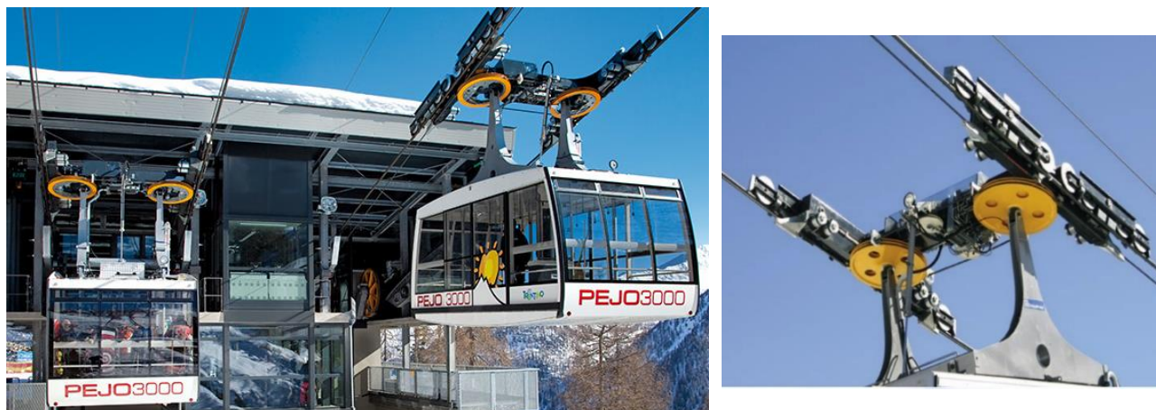
Figura 13: Sistema Funifor con due cabine e specificità del carrello e della sospensione 7
