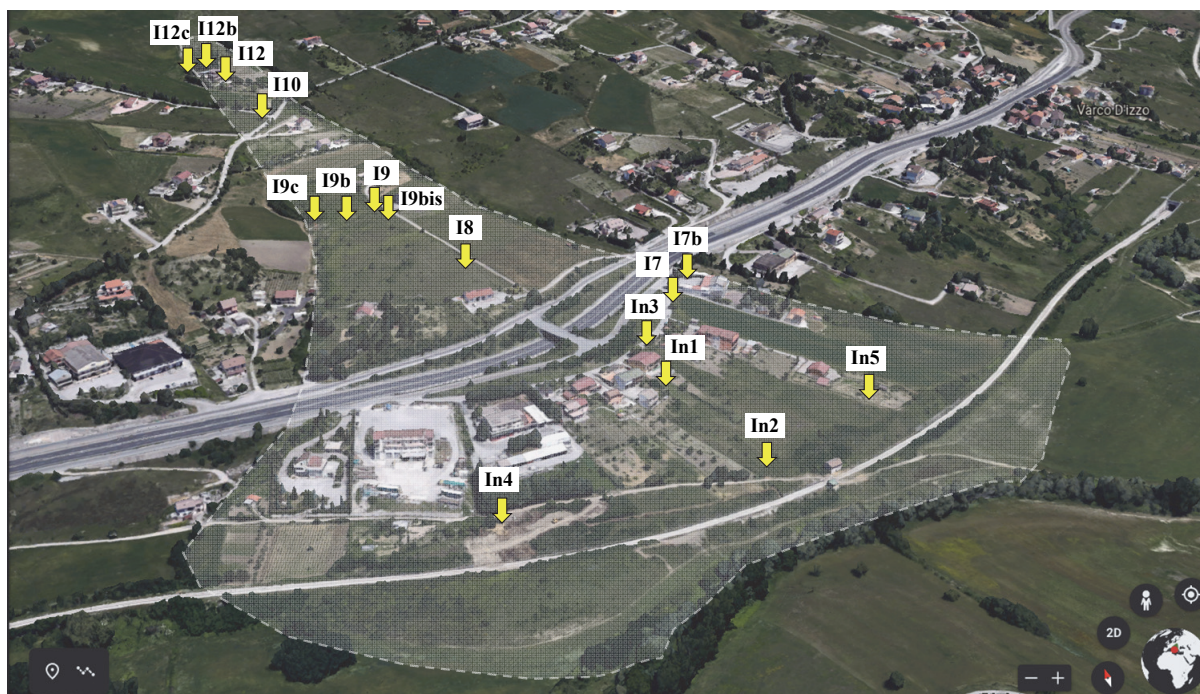
Figura 4: Ubicazione dei fori di sondaggio attrezzati con tubi inclinometrici. I fori In-i e il foro I9bis sono stati realizzati da R.F.I., gli altri fori da UniBas.
