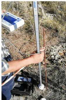
Sonda capacitiva per il monitoraggio del contenuto d'acqua con la profondità
