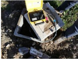
Monitoraggio della pressione interstiziale tramite piezometri elettrici
