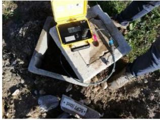
Monitoraggio della pressione interstiziale tramite piezometri elettrici
