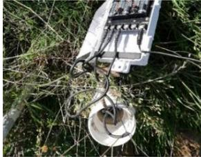
Monitoraggio di temperatura tramite sonda MPS-6
