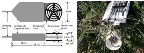
Monitoraggio della Suzione tramite sonda MPS-6
