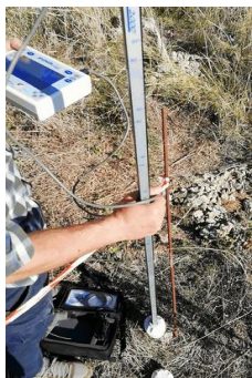
Sonda capacitiva per il monitoraggio del contenuto d'acqua con la profondità (Diviner 2000)
