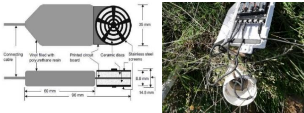
Monitoraggio della Suzione tramite sonda MPS-6
