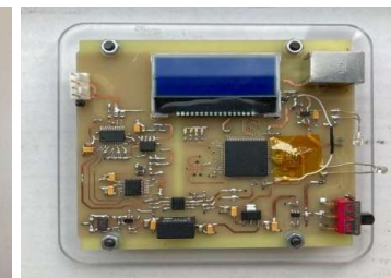
circuito convertitore di impedenza costituenti il dispositivo di misura
